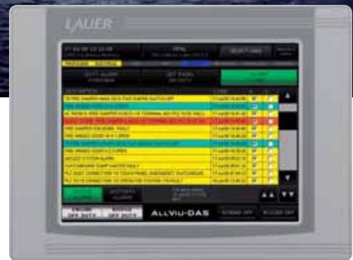
Der 8,4 Zoll Nautic-PC von LAUER dient als Duty Alarm Panel in der Ingenieurskabine.
